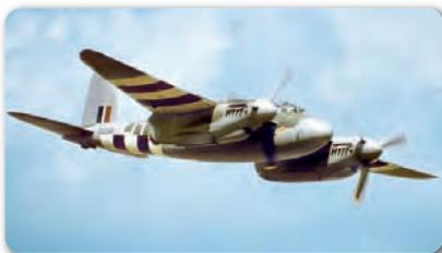
Costruito in 13.000 esemplari, era un bimotore con struttura in legno, nelle versioni caccia e caccia-bombardiere. Rappresentò una vera macchina rivoluzionaria, con elementi innovativi, dal timone agli alettoni fino alla cabina di pilotaggio dotata di visibilità notevole, disposta per accogliere pilota e navigatore affiancati come su di una comune auto. Nelle ultime versioni caccia, poteva raggiungere una velo-
