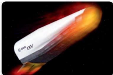
Ricordiamo che il progetto intende sviluppare un mezzo autonomo europeo di rientro dallo spazio, caratterizzato da elevata aerodinamicità, da un sistema di controllo ad alte prestazioni e da un innovativo sistema di protezione termica durante il rientro nell'atmosfera.
